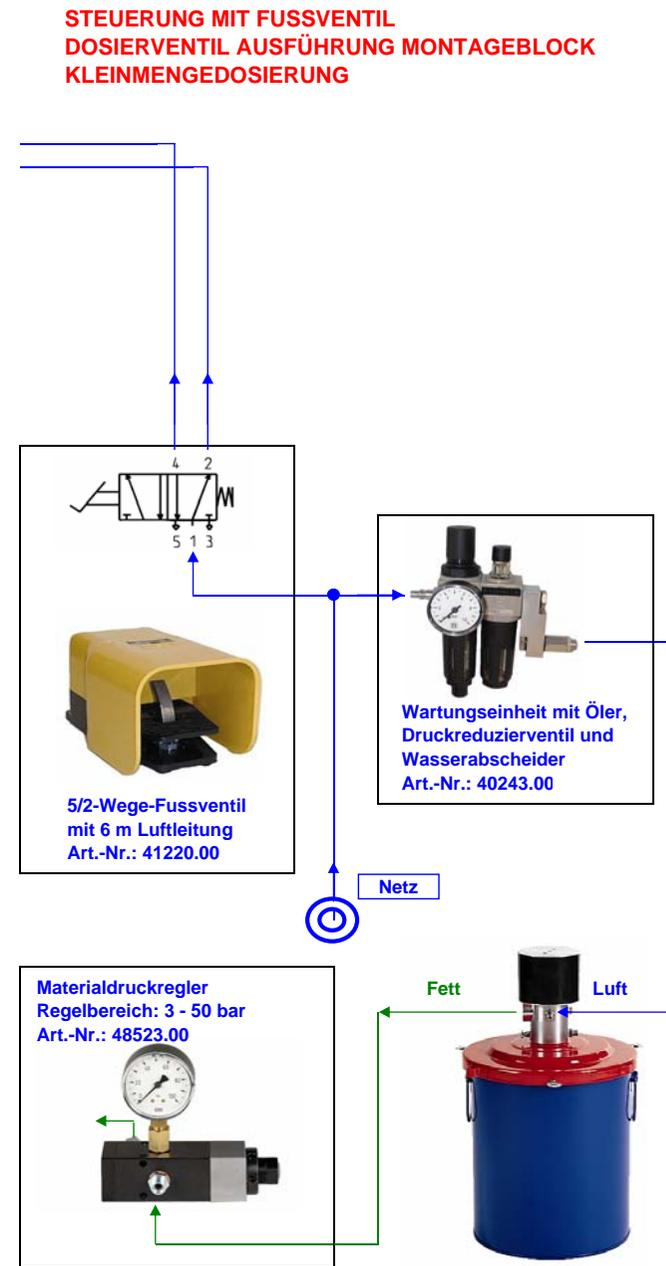
PNEUMATISCHE SCHMIERANLAGEN - DRUCKÜBERSETZUNG 10:1 und 20:1 - AUSRÜSTUNG MIT DOSIEREINHEIT
