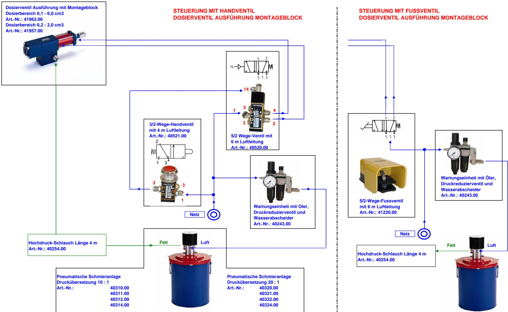
PNEUMATISCHE SCHMIERANLAGEN - DRUCKÜBERSETZUNG 10:1 und 20:1 - AUSRÜSTUNG MIT DOSIEREINHEIT
