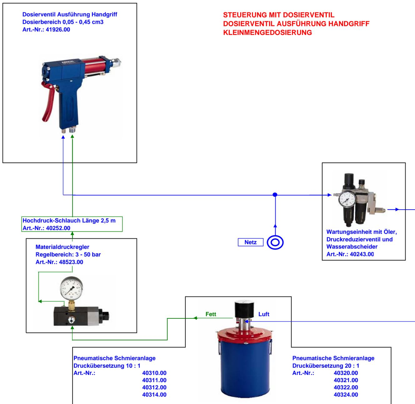
PNEUMATISCHE SCHMIERANLAGEN - DRUCKÜBERSETZUNG 10:1 und 20:1 - AUSRÜSTUNG MIT DOSIEREINHEIT
